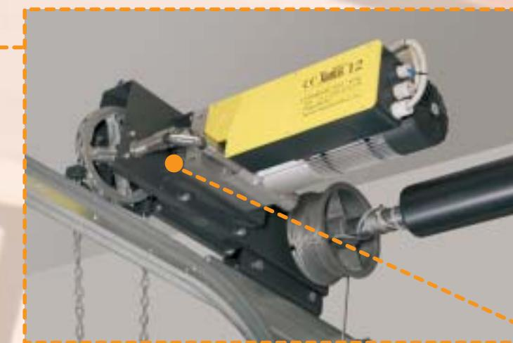
Il sistema TAURUS COMPACT (MOTORE, ALBERO, PULEGGE, ANTICADUTA), può essere **installato separatamente dalla porta sezionale** poiché non è collegato a guide o supporti della porta stessa. Il motore è innestato sulla bandiera ed è completamente separabile dal resto dell'impianto, pertanto la sua eventuale manutenzione risulta notevolmente facilitata.
